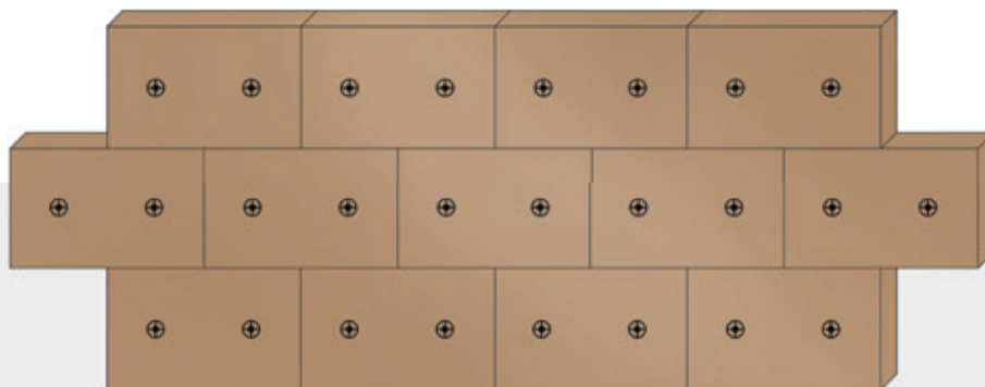
Snelle en economische bevestiging: voorbeeld met 2 pluggen per plaat.
