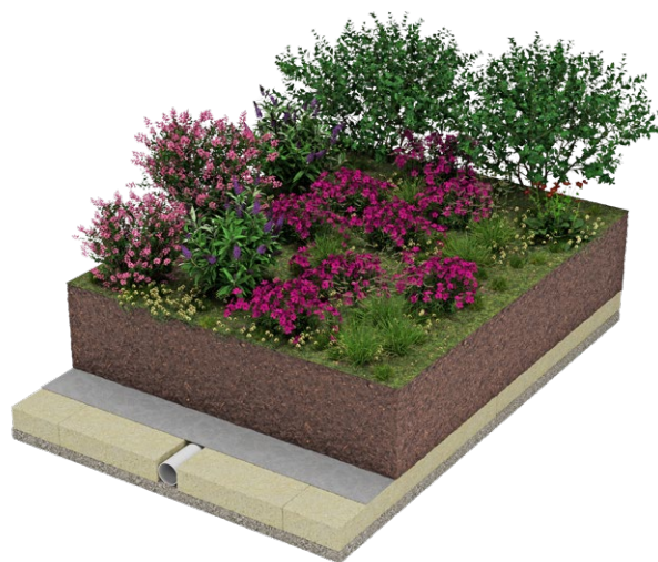
Schematische weergave Rockflow FloraSponge
